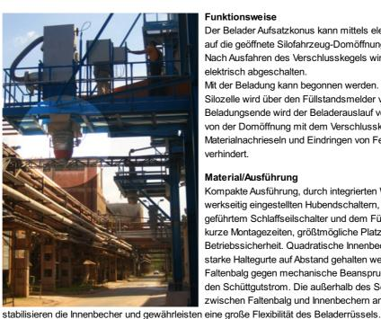
Der Belader Aufsatzkonus kann mittels elektrischer Steuerung auf die geöffnete Silofahrzeug-Domöffnung abgesenkt werden. Nach Ausfahren des Verschlusskegels wird der Windenmotor elektrisch abgeschalten.
